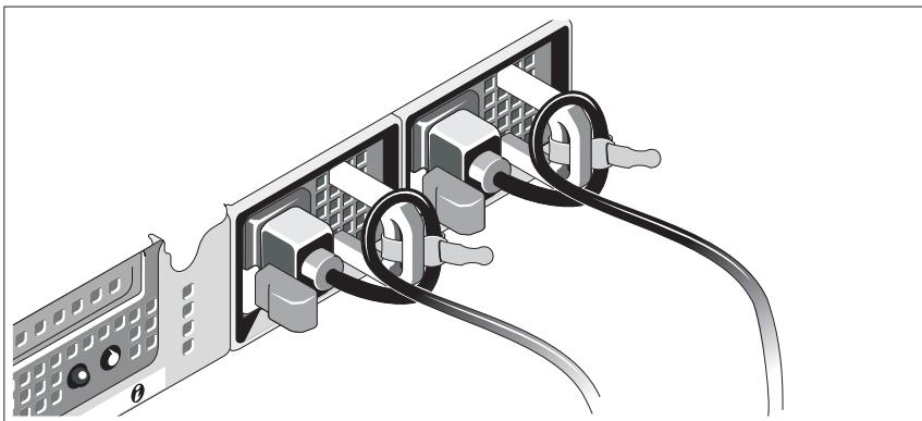
電源コード固定プラケットを電源ユニットハンドルの右ベンドに取り付けます。システムの電源ケーブルをループ状に曲げ（図を参照）、プラケットのケーブル留め金に取り付けます。
