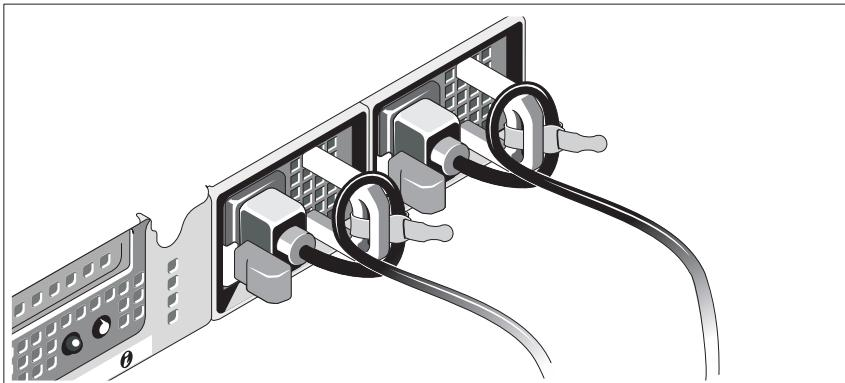
전원 공급 장치 핸들의 오른쪽 벤드에 있는 전원 코드 고정 브래킷을 연결합니다. 그림과 같이 시스템 전원 케이블을 고리 안으로 구부려서 브래킷의 케이블 결쇠에 연결합니다.
