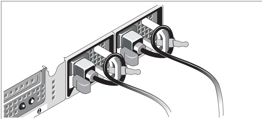
Pasang braket penahan kabel daya di sisi sebelah kanan tangki catu daya. Tekuk kabel daya sistem secara melingkar seperti ditunjukkan pada gambar kemudian kencangkan kabel dengan pengikat kabel braket.
